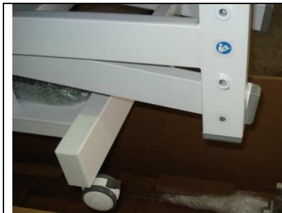
Fig-7 - Esta figura mostra os dois furos de encaixe para a haste ao lado esquerdo da mesa.
