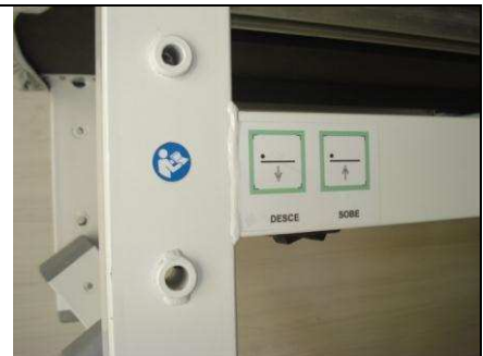
Fig-9 - Furos de posicionamento da Haste no lado oposto onde se observa o posicionamento de uma das Botoeiras.
