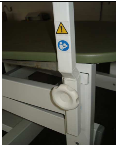
Fig-8 - Haste posicionada e travada através do manipulô com rosca.
