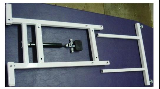
1- Encaixe a base do deslizador (8) nos suportes (6 e 9), apertando levemente os parafusos. (Este conjunto está montado na sua posição mais baixa) Para regulagem da altura da mesa, deve-se soltar os quatros manípulos, posicionar na altura desejada e prender com os manípulos, sendo dois a dois.
