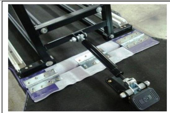
3 – Após posicionamento dos suportes e tubos, proceder montagem da mola à gás. Retire o eixo roscado e as buchas de nylon e encaixe da mesma forma no suporte que está fixado no tampo móvel.
