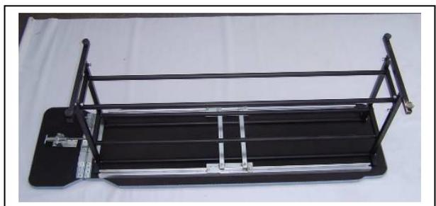
5 – Coloque os outros 4 tubos e aperte com a chave 1/2" x 9/16" os parafusos 5/16" x 2" (com arruela). Após isto, aperte com a chave Philips 1/4" x 6" os parafusos (8 unid.) chip 4,5 x 40 mm. Vire o conjunto, para a posição normal de trabalho.
