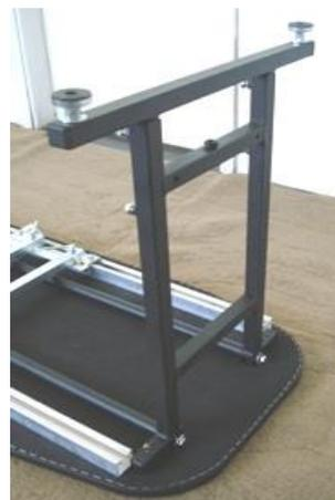
4 – Encaixe o suporte anterior conforme indica a figura e prenda com os parafusos do Kit de montagem.
